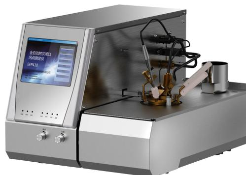
全自动快速平衡法闪点测定仪 (V1.0)
